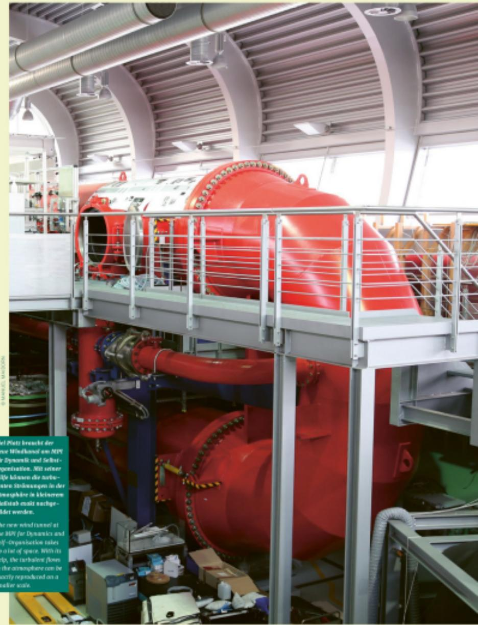
Tief Platz braucht der neue Windkanal am MPI für Dynamik und Selbstorganisation. Mit seiner Hilfe können die komplexen Strömungen in der Atmosphäre in kleineren Modellen mit detaillierteren Bildern wiedergegeben werden.
